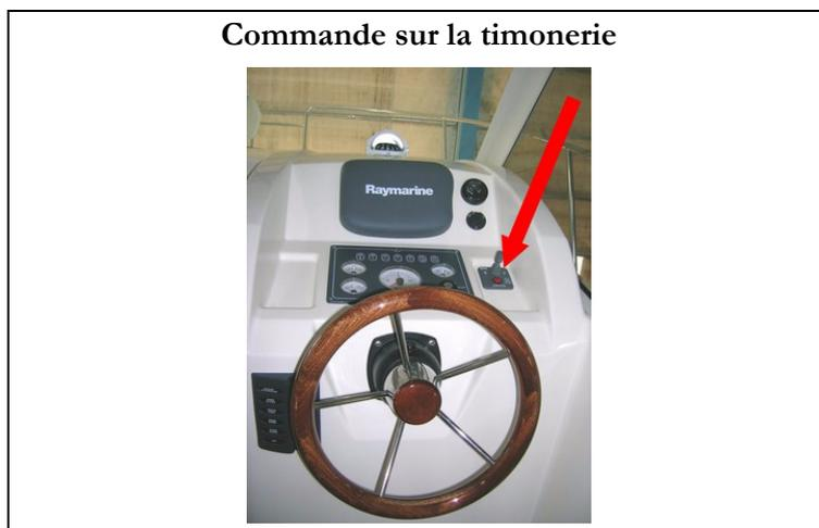
Le propulseur fonctionne moteur du bateau allumé.
