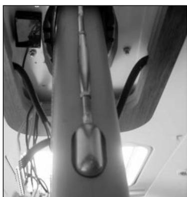
Le mât posé, les messagers des câbles sortant du mât, mettre en place la coquille et le ridoir du tirant d'étambrai.
