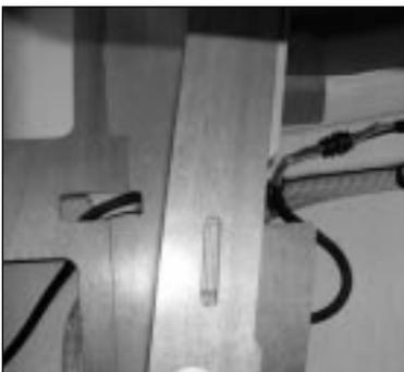
Le faisceau passe sous les planchers pour ressortir dans le coffre bâbord où seront effectués les branchements.
