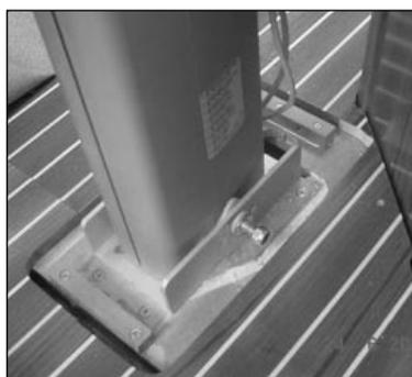
La position de l'axe préconisée par le chantier est l'insertion dans le perçage central.
