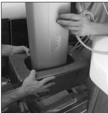
Avant de poser le mât, enfiler le boîtier (attention à repérer le sens avant/arrière) et le maintenir dégagé du pied de mât.
