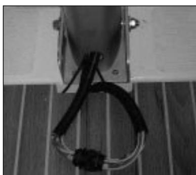
Mettre en place le plancher après avoir connecté les prises des faisceaux électriques.
