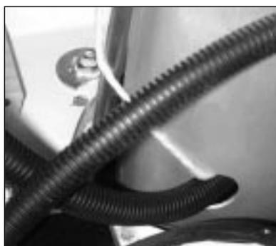
A l'aide d'un messenger passer le faisceau électrique du pont de la lumière d'étambrai à la lumière de pied de mât.
