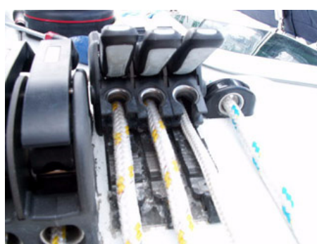
Passer le cordage Remonter le bloqueur en procédant à l'inverse du démontage
