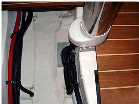
Sortie du faisceau de mât en bas de l'épontille
