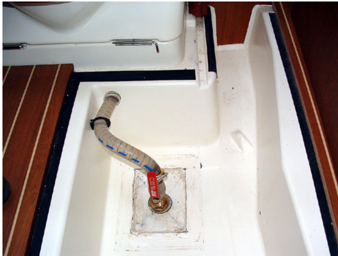
Passe-coque avec vanne de prise d'eau moteur
