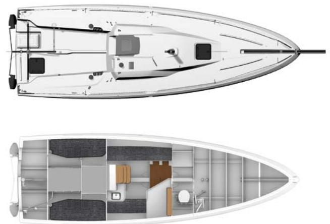
**F** | La coque (monolithique) et le pont (sandwich) du Sun Fast 30 One Design sont fabriqués selon la méthode de l'infusion sous vide avec de la résine thermoplastique Elium®, mise au point par Arkema.
