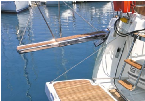
Retractable hydraulic passerelle / Passerelle hydraulique rétractable
