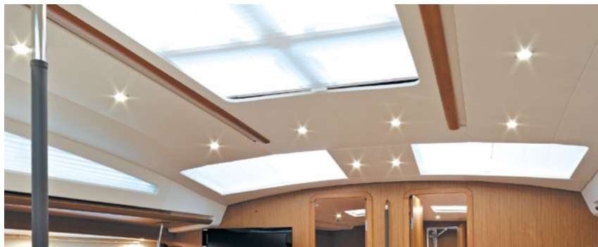
Saloon skylight - LED lighting with dimmers / Verrière dans le carré - Eclairage LED avec variateur
